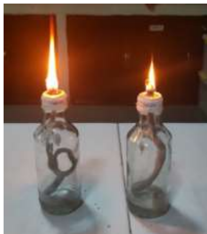
Gambar 4.4 Hasil Uji Titik Nyala (Kiri: Minyak Tanah, Kanan: Produk Distilat)
