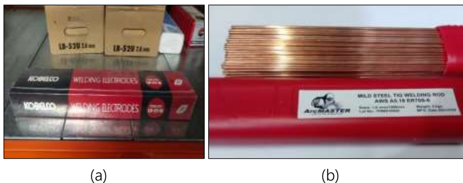
Gambar 3.13 : Elektorda las : (a) SMAW E7018 ; (b) GTAW ER70S-6
