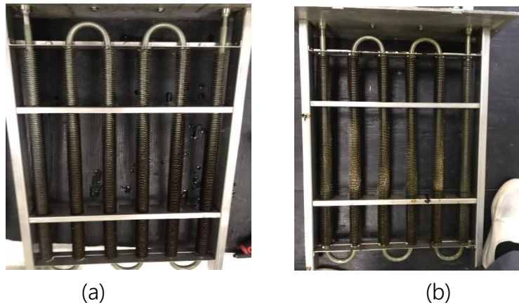
Gambar 4. Perbedaan penggunaan cairan Contraflux-FM dan Isopropyl Alcohol
