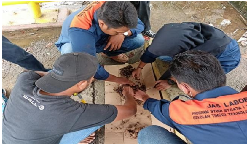
Gambar 6. Klasifikasi Secara Visual Auger Boring
