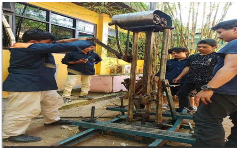
Gambar 2. Pelaksanaan Pengujian Alat Sondir (CPT)
