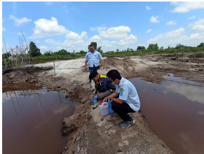
Gambar 3. Pengujian Parameter pH Air Dari Bekas Kolam Tambang Pasir
