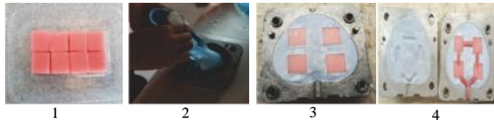
Gambar 1. model master dari malam merah, 2. Penuangan adonan gips dalam kuvet, 3. Penanaman model induk pada kuvet bawah, 4. Pemasangan spru dan pengisian kuvet atas (Sumber: Dokumentasi Pribadi)
