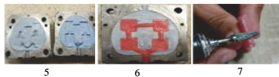
Gambar 5. Pembuangan model induk dan spru, 6. Pembuatan lempeng resin poliamida, 7. Merapikan tepi yang tajam. (Sumber: Dokumentasi Pribadi)
