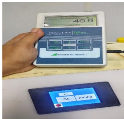
Gambar 5. Pengukuran Daya Hisap Dengan DPM
