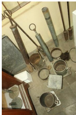
Gambar 5. Mold dan Hammer ( Proctor Test )
