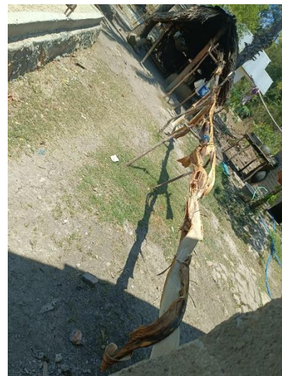
2b. Pipa penyulingan ±10 meter
