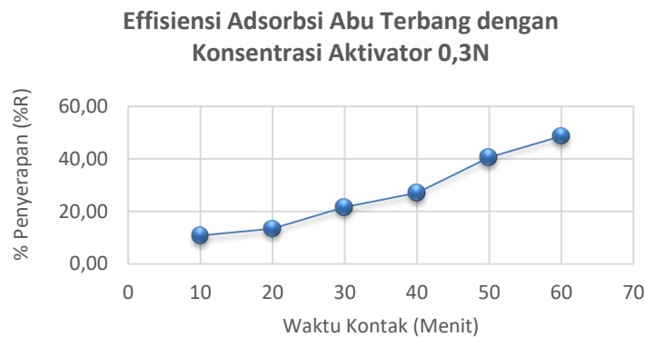
Gambar 2. Effisiensi Adsorpsi Abu Terbang Menyerap Amonia dalam Air Limbah dengan Konsentrasi Aktivator 0,3N
