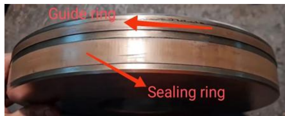
Gambar 1. guide ring & sealing ring aus Sumber: MV. PAN IVY
