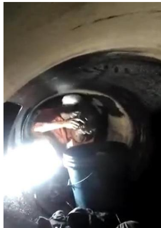
Gambar 6. Pembersihan ruang udara bilas
