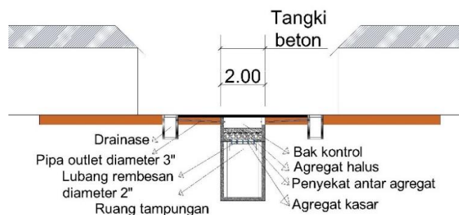
Gambar 7. Detail drainase dan tangki beton
