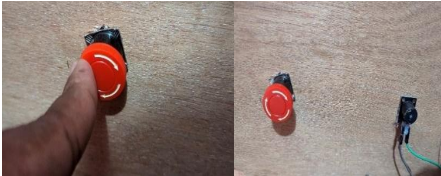
Gambar 15. Pengujian Tombol MCP ketika ditekan
