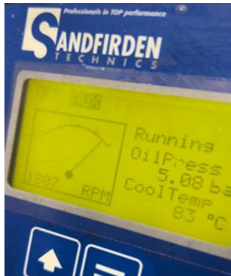
Gambar 13. Suhu Normal Cooling Fresh Water 83°C Pada A/E Nomor 3 Scania DI 13 074. (Sumber: Dokumen Peneliti di MV Meratus Payakumbuh)
