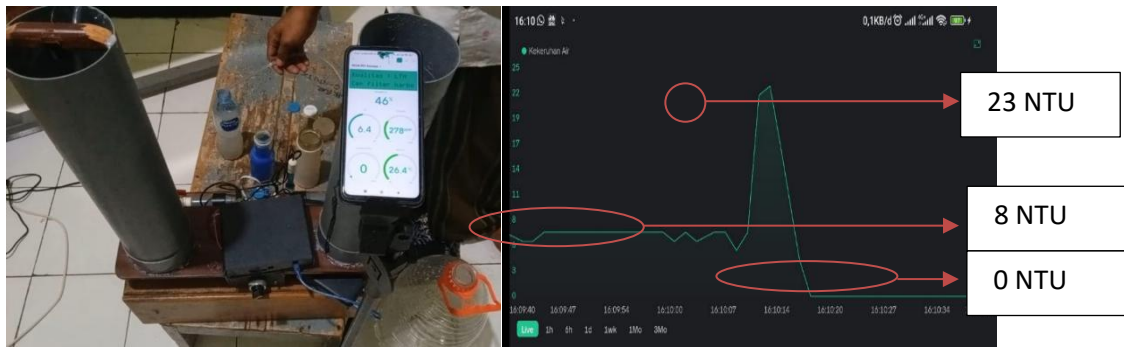
Gambar 13. Implementasi 3 sensor melebihi ambang (kiri atas) Sensor TDS Melebihi Batas (kanan atas) Implementasi Sensor pH (kiri bawah) dan Histori Sensor Kekeruhan (kanan bawah)
