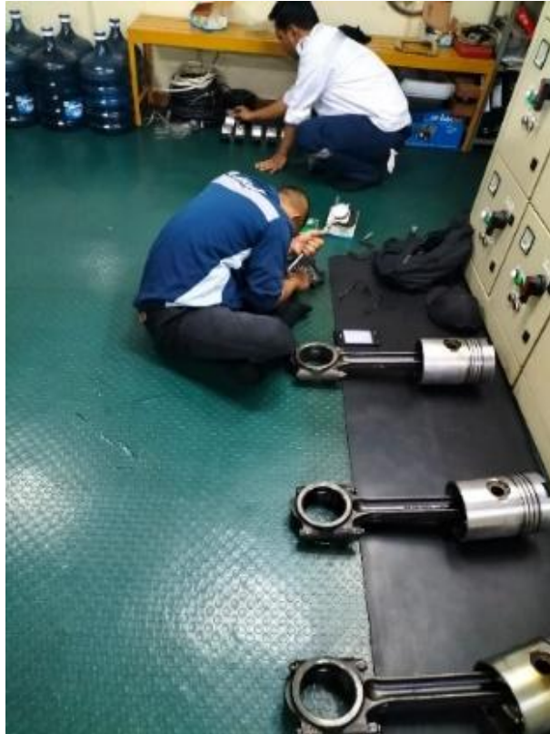
Gambar 5 Proses Pengecekan terhadap Piston (Sumber : Dokumen Peneliti)
