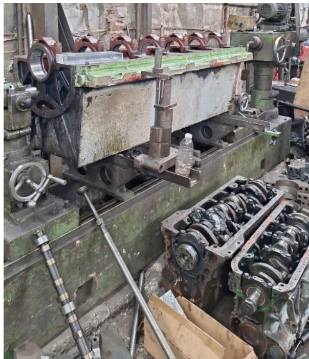
Gambar 7 Proses Centerline (Sumber : Dokumen Peneliti)
