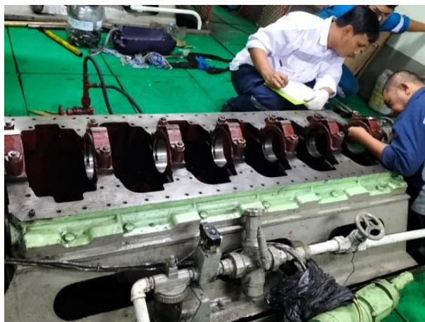
Gambar 6 Proses Pengecekan terhadap Crankshaft (Sumber : Dokumen Peneliti)
