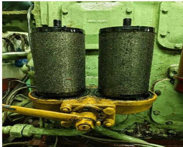
Gambar 9 Filter oli Kotor (Sumber : Dokumen Peneliti)
