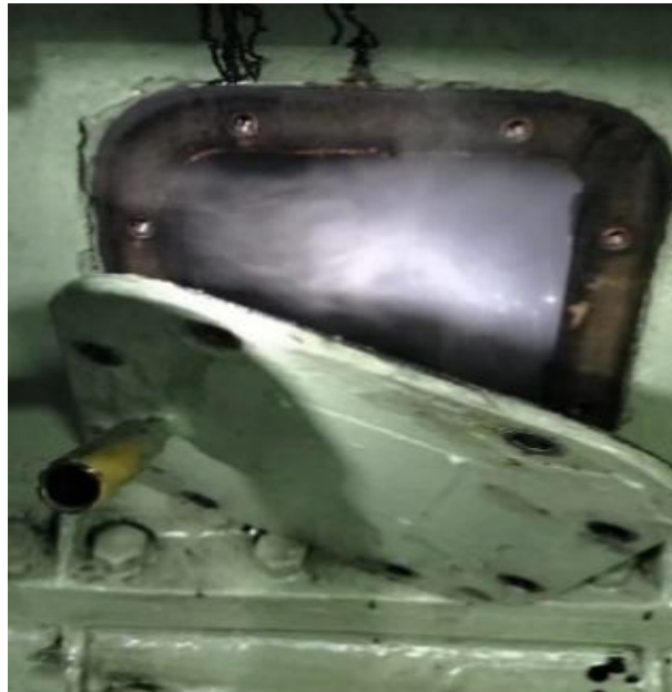
Gambar 2 Blok Mesin ditemukan adanya asap (Sumber : Dokumen Peneliti)
