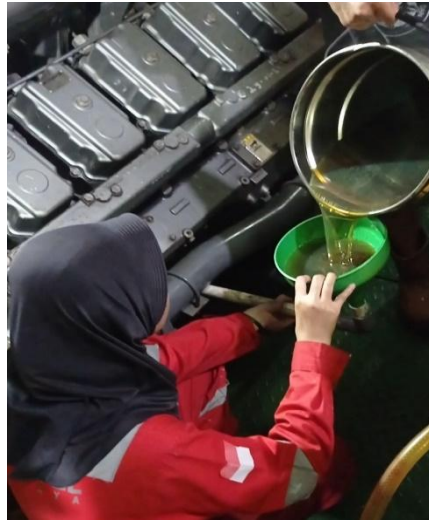
Gambar 12 Penggantian Minyak Lumas
