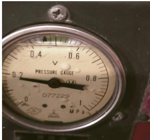
Gambar 7 Penurunan Tekanan Minyak Lumas
