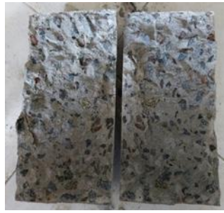
Gambar 8. Gambar Tarik Belah Beton Normal (Sumber : Dokumentasi pribadi)
