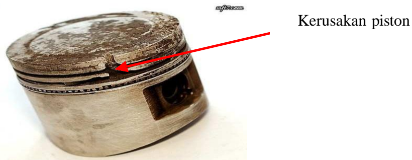
Gambar 1. Kerusakan pada piston (www.Metalurgi.com)
