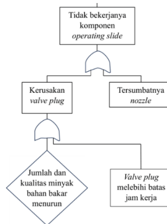
Gambar 15. Fault Tree Tidak bekerjanya Operating Slide (Sumber: Dokumen Pribadi, 2024)
