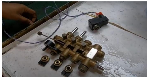
Gambar 9. Pembersihan Valve block water (Sumber: Dokumen Pribadi MT Capella)
