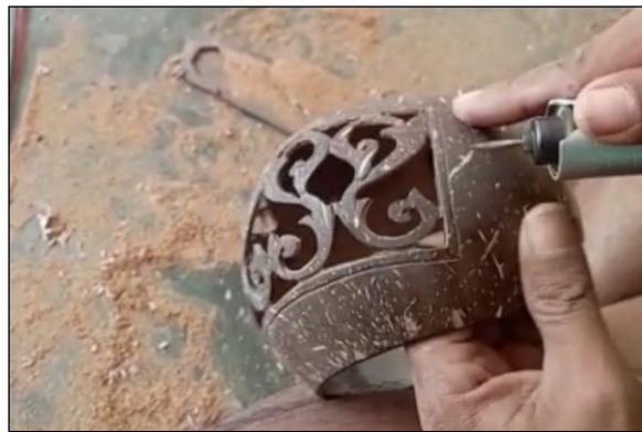
Gambar 6. Proses Pengukiran menggunakan Bor Khusus
