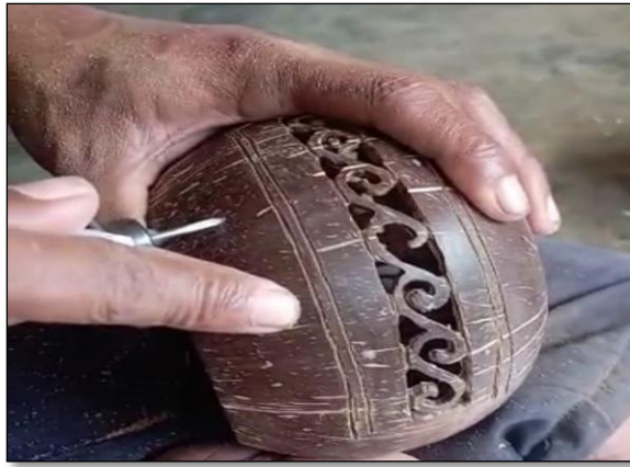
Gambar 5. Proses Pengukiran menggunakan Bor Khusus
