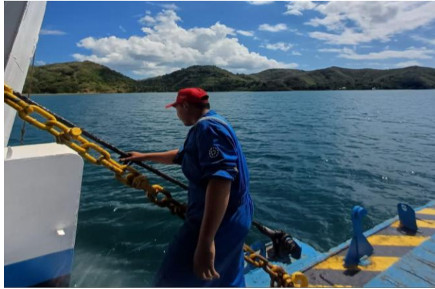
Gambar 4. Pemberian Pelumas Pada Wire Rampdoor
