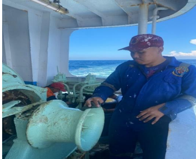
Gambar 3. Pembersihan Karat Pada Winch
