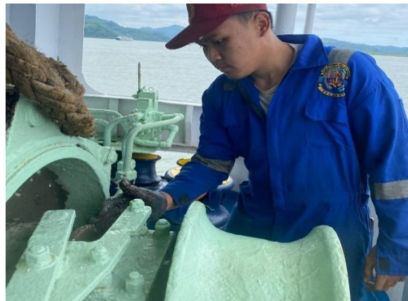
Gambar 5. Pemberian Pelumas Pada Winch
