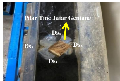
Gambar 6. Letak Titik Pengukuran Gerusan Pada Model Pilar Jajar Genjang
