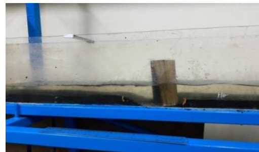
Gambar 11. Pola Gerusan Pada Pilar Jajar Genjang Tampak Atas dan Samping
