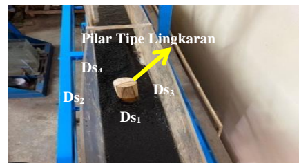
Gambar 5. Letak Titik Pengukuran Gerusan Pada Model Pilar Lingkaran
