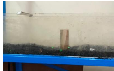
Gambar 9. Pola Gerusan Pada Pilar Lingkaran Tampak Atas dan Samping
