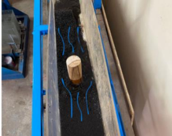
Gambar 9. Pola Gerusan Pada Pilar Lingkaran Tampak Atas dan Samping
