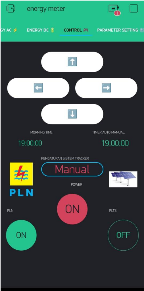
Gambar 5. Pengujian Fungsi ATS Mode Manual PLN
