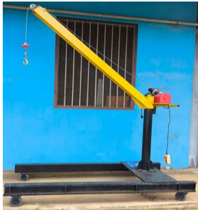
Gambar 2. Alat bantu angkat komponen mesin dan material
