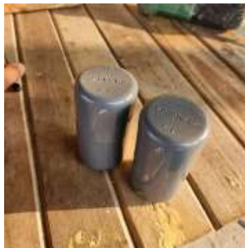
Gambar 8. PVC untuk Roller Konveyor
