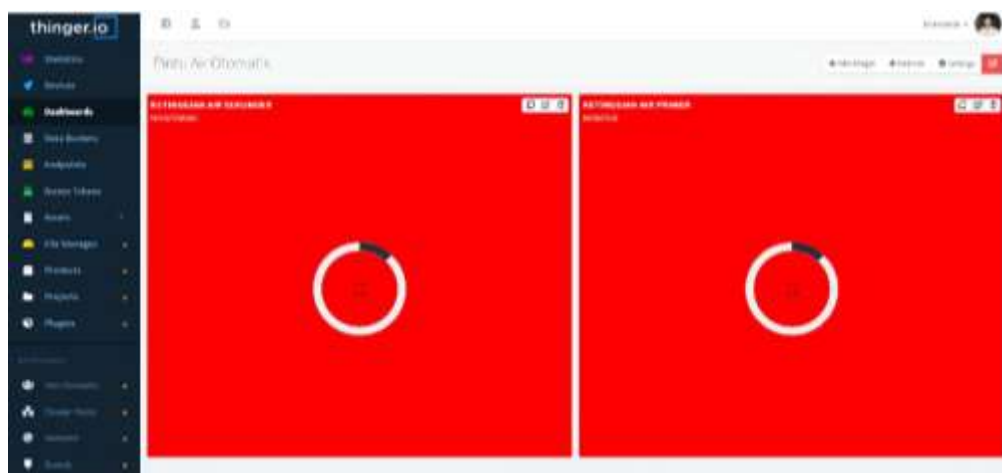
Gambar 8. Notifikasi pada web Thinger.io untuk kondisi level air >10 cm
