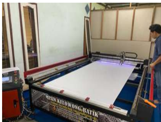
Gambar 15. Proses Pencetakan Batik Menggunakan Mesin CNC
