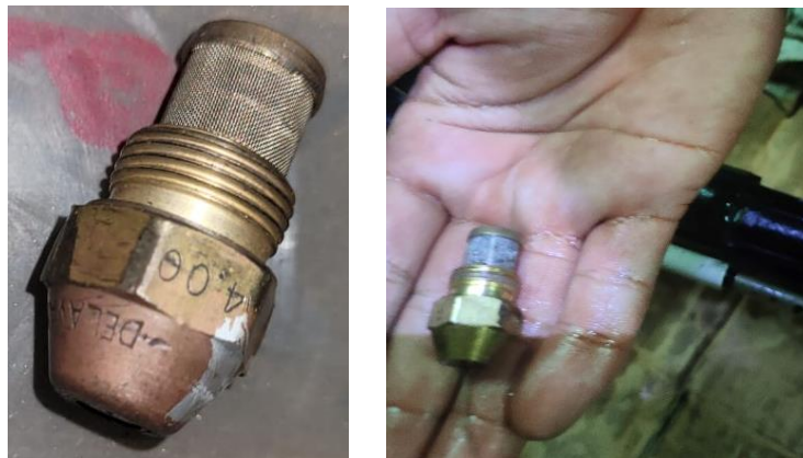
Gambar 9 Pembersihan Nozzle (Sumber: data pribadi)
