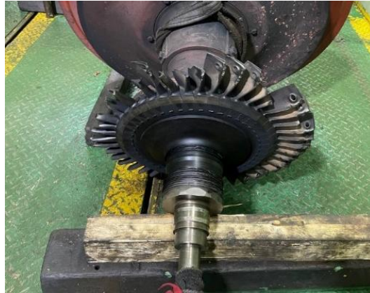
Gambar 12. Kerusakan Turbin Blade Turbocharger (Sumber : Dokumen KM Sirimau)
