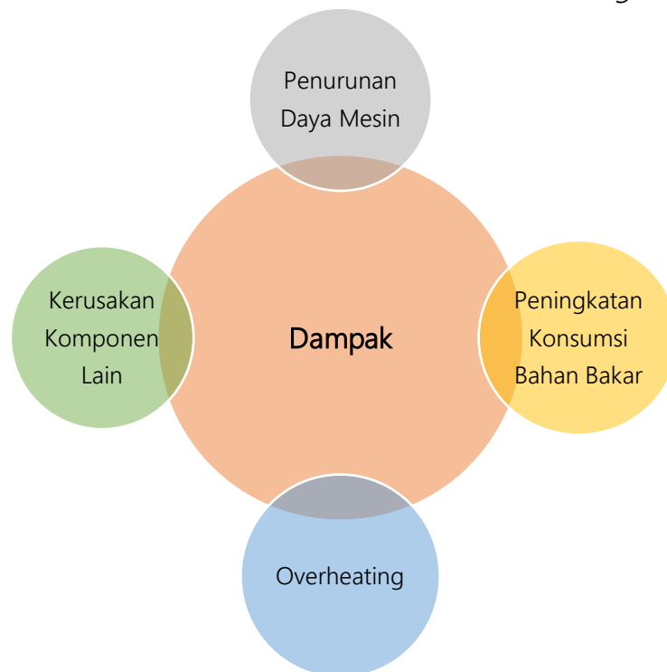
Gambar 15. Dampak Kerusakan Turbin Blade Turbocharger (Sumber : Dokumen Peneliti)
