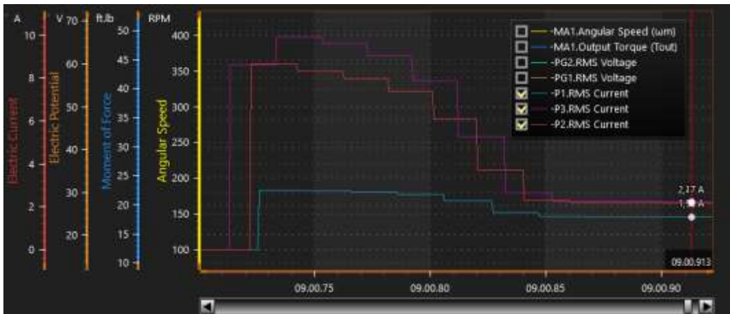
Gambar 6. Grafik hubungan tegangan dengan pemasangan rheostat 100 ohm
