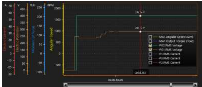
Gambar 9. Grafik Hubungan Tegangan dengan Pemasangan Rheostat 200 Ohm
